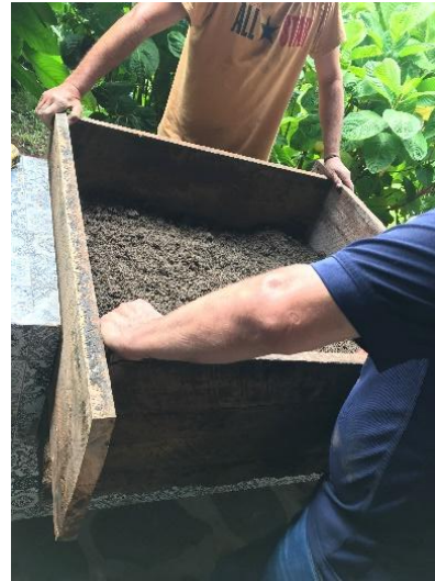
Figura 137. Construcción del molde para la estufa.
