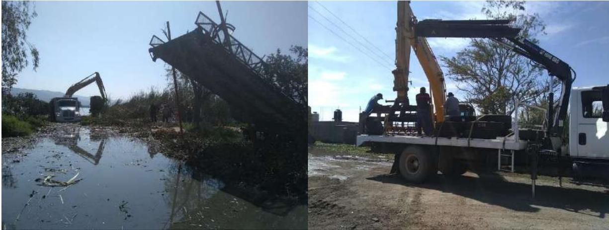
**Figura 5. Maquinaria para la extracción de lirio acuático y tule flotante.**
