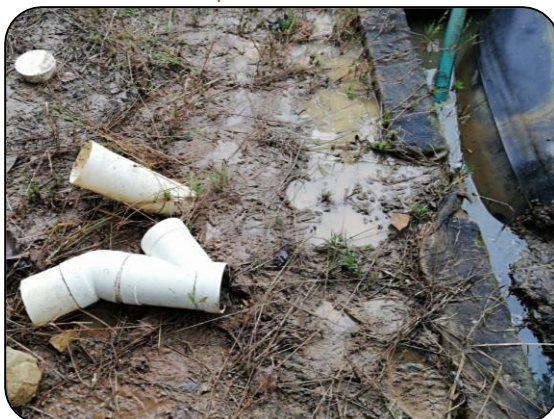
Figura 23. Brida de influente de reactor averiado en rastro de Pihuamo.
