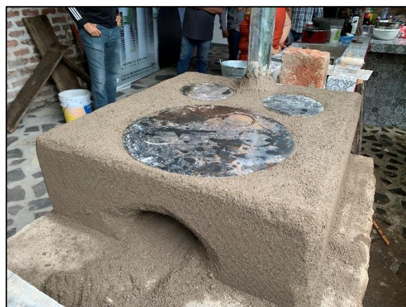
Figura 46. Estufa ahorradora de leña terminada.
